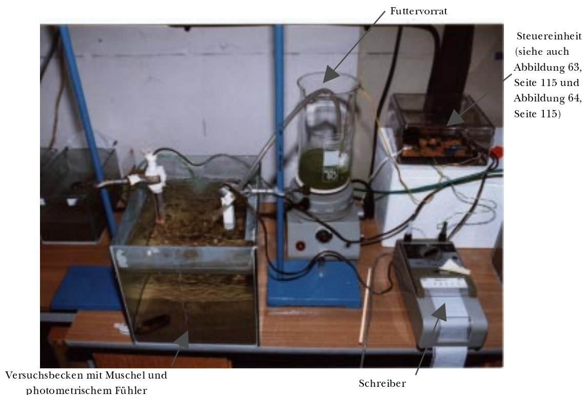
Abbildung 17: Der Versuchsaufbau der Filtrationsmessung.
